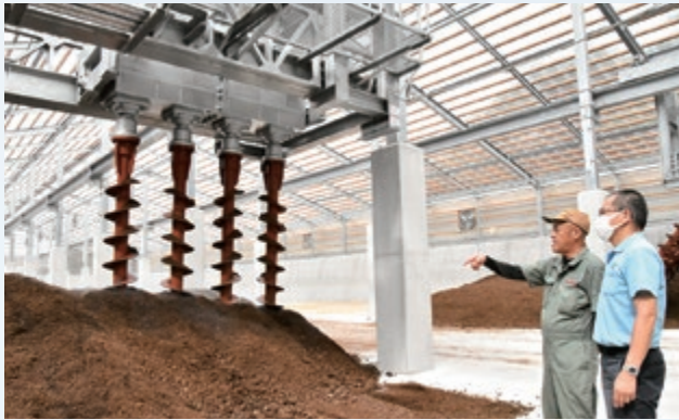
4本のスクリーが堆肥をかく拌し発酵を促します
